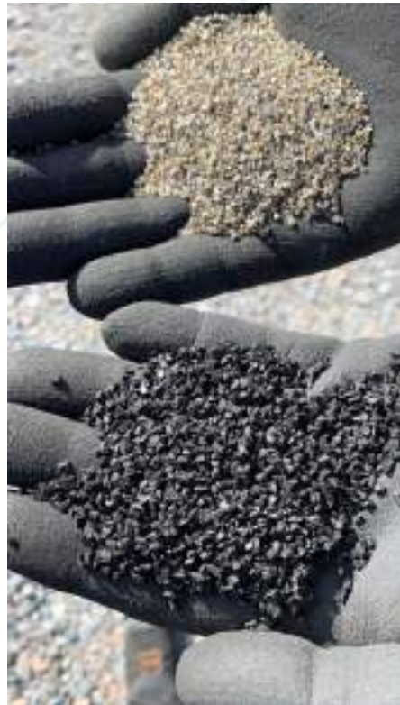
Sand og SBR/TPE/EPDM fjernes, renses, tørkes og plasseres i big-bags, klargjort for gjenbruk
